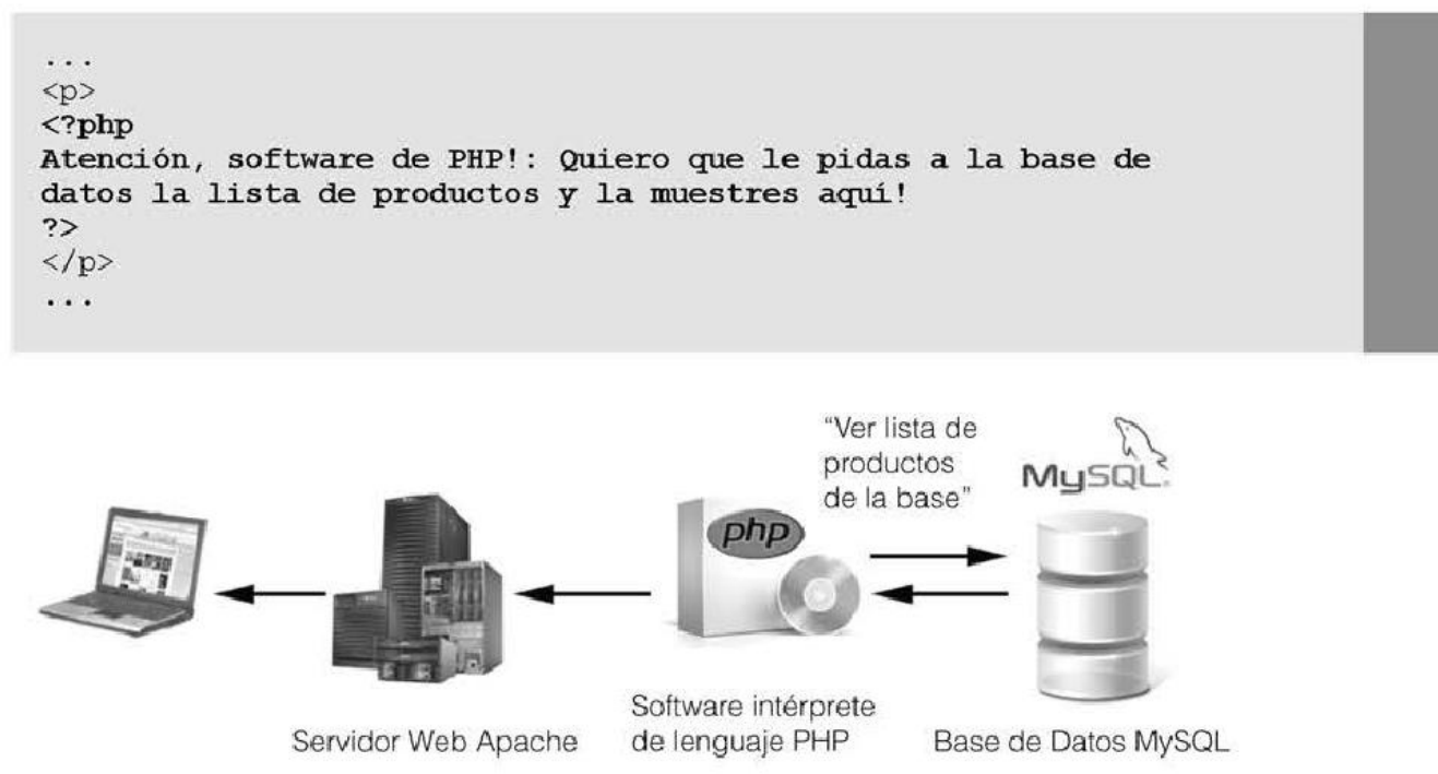
Figura 1-13. Esquema del circuito de una página que muestra información almacenada en una base de datos.
