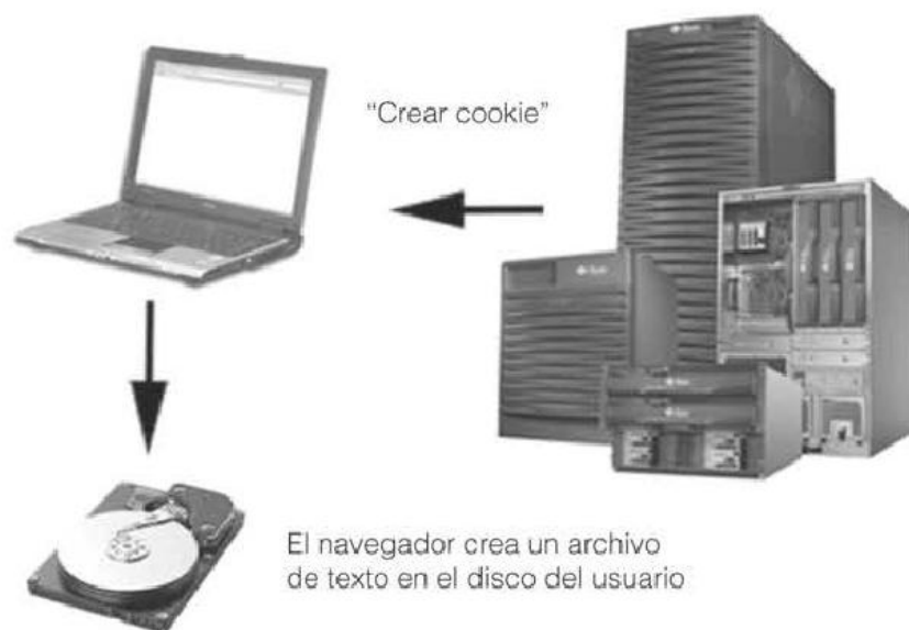
Figura 7-1. El servidor Web le pide al navegador que cree una cookie .
