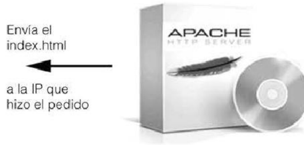
Figura 1-4. El servidor Web envía el archivo solicitado a la dirección IP del navegador.
